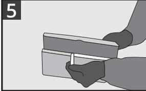
Retire el respaldo blanco de la tira adhesiva y fíjelo al piso seco cerca del borde del derrame.
